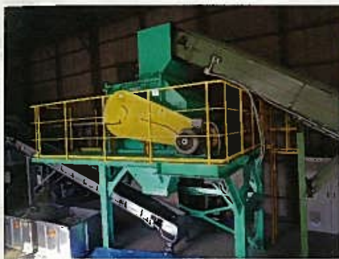
電子基板からタンタル素子を回収するライン(左)。精錬業者にて受け入れ可能な状態にまで分別・回収する(上)
