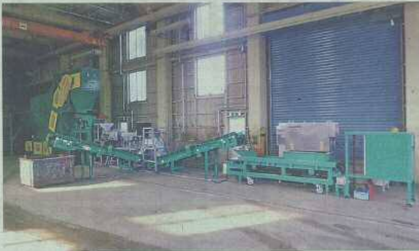
ハリタ金属が開発したLIBSレーザーの実証機
