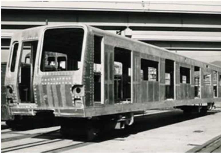
写真1 有楽町線7000系 車体と類似の千代田線6000系量産車の車体
