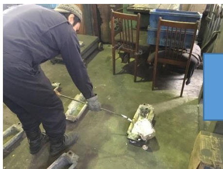
溶解後、アルミを型枠へ流し込む。
