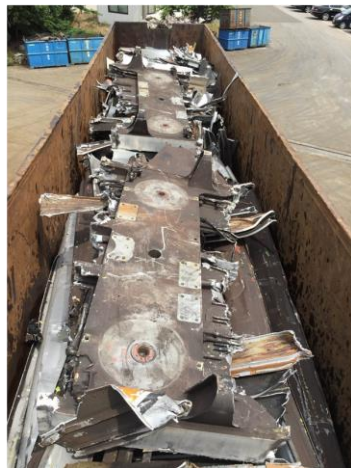
重機解体選別された車両アルミ
