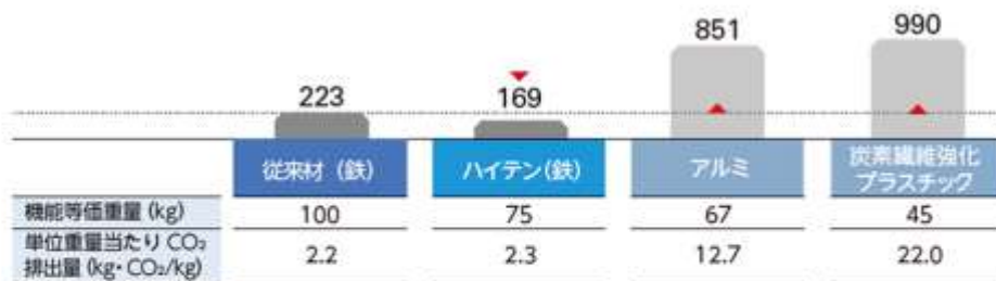
図2 従来材(鉄)100kgと同じ強さの自動車部材をつくる時のCO 2 排出量比較(kg・CO 2 )
