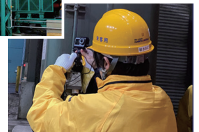
図3 処理速度のカメラ計測の様子
