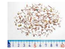
金銀銅滓、レアメタル 金銀銅滓 1t中に100g以上の「金」が含まれています(佐渡金山は、鉱石 1t中に約 3gでした)。金以外に銀、銅、パラジウム等も含まれます。
